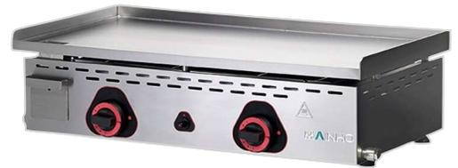
**NS:** Planchas profesionales construidas completamente en acero inoxidable 18/8 - Placa de Acero Rectificado de **15mm de espesor** - Disponen de cajón recolector en el frontal de la máquina - Incorporan válvula de gas con dos intensidades de calor, termo par de seguridad y encendido por tren de chispas a batería - En dotación incluyen: Espátula pequeña.
